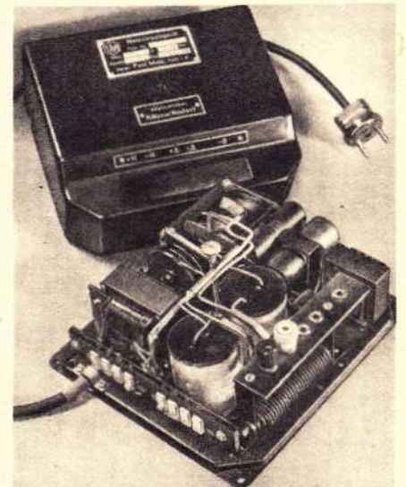
Abb. 4. Das Netzvorsatzgerät und sein Gehäuse. Links vorn die Umschaltleiste für die Heizstrom-einstellung, dahinter nach rechts oben Netztransformator, Heizgleichrichter und Heizdrossel. Im Vordergrund die Anschlußleiste für Heiz-, Anoden- und Gitterspannung, darunter der Anodenspannungsgleichrichter, daneben die Anodensiebkondensatoren. Aufnahme: Stumpf
